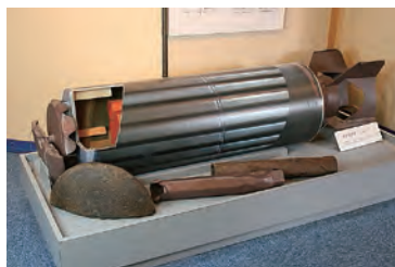
集束焼夷弾の原寸模型。空中で外殻が外れて38本のM69焼夷弾がバラまかれます
